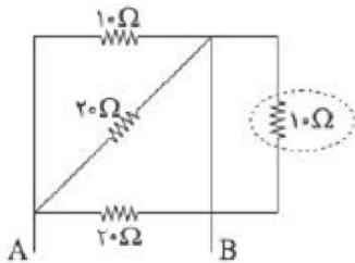
مقاومت مشخص شده، اتصال کوتاه بوده و از مدار حذف می‌شود.
