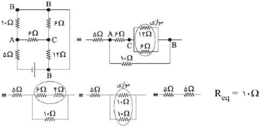
گزینه ۳ پاسخ صحیح است. دو مقاومت ۲R در پایین شکل موازی هستند و می‌توان به جای آن‌ها
