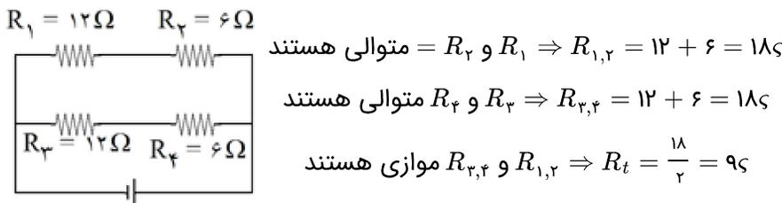
با بستن کلید K، مقاومت معادل مدار به صورت زیر تغییر می‌کند:
